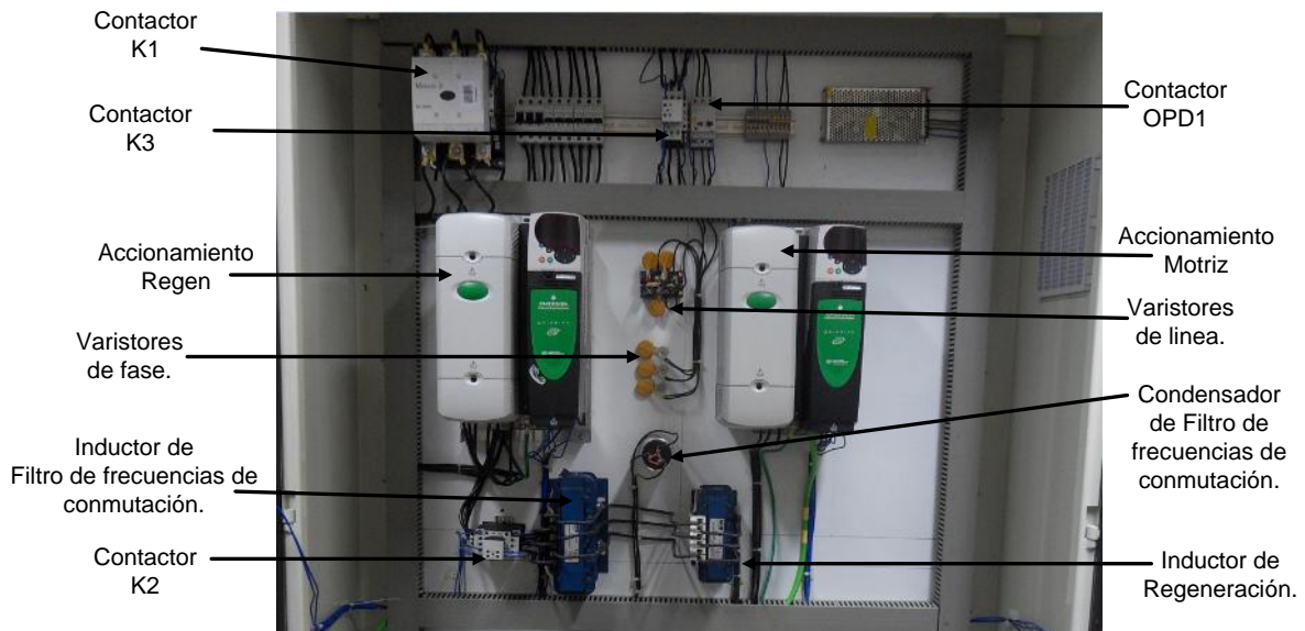
Figura 3. 6 Implementación del sistema regenerativo.
