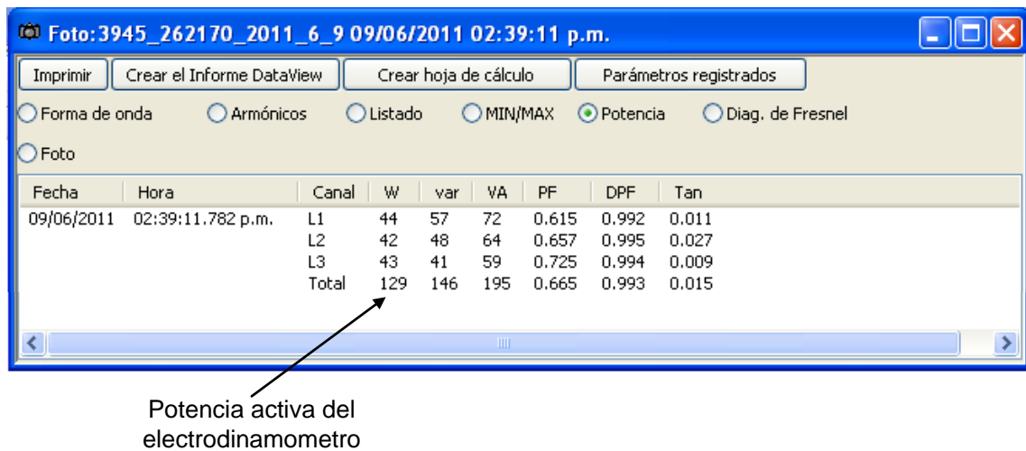
Figura 5. 6 Mediciones de potencias en las terminales del electrodinamómetro con un AEMC instruments 3945-B.
